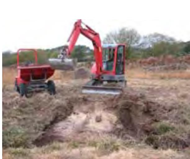
Mini-pelle de 5 tonnes et dumper de 1 000 litres à Kercadoret
