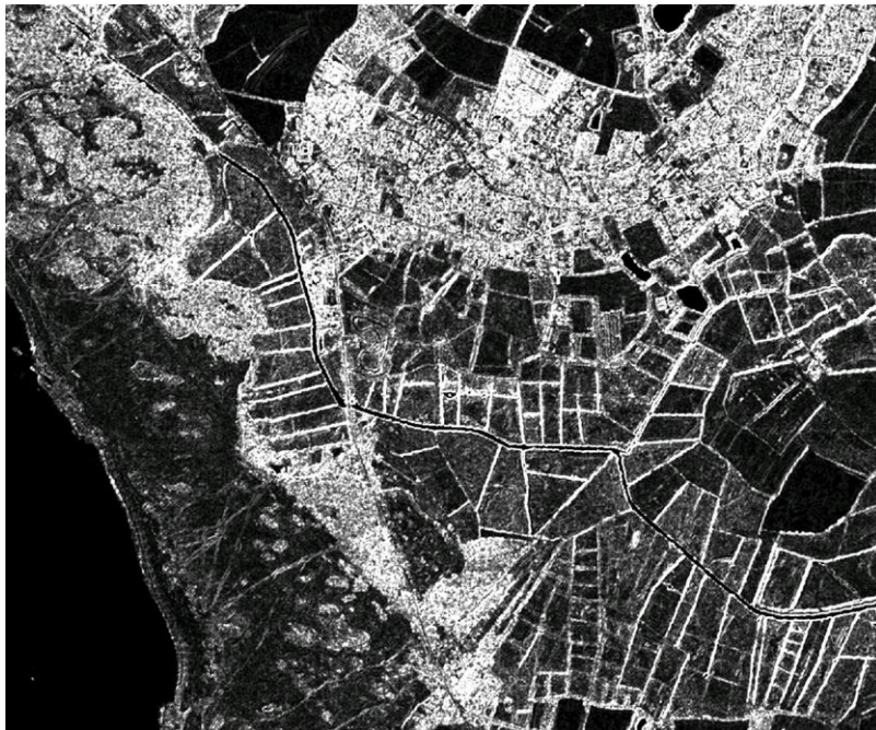
Figure 3 – Extrait de l'image de dissimilarité obtenue à partir de la bande 7 (0,77-0,89 \mu\text{m} ). Les éléments du paysage d'aspect lisse, tels que les surfaces en eau ou les sols nus, sont caractérisés par une faible dissimilarité (teintes noires) alors que les éléments du paysage d'aspect rugueux, tels que les arbres ou les surfaces bâties, sont caractérisés par une forte dissimilarité (teintes blanches).
