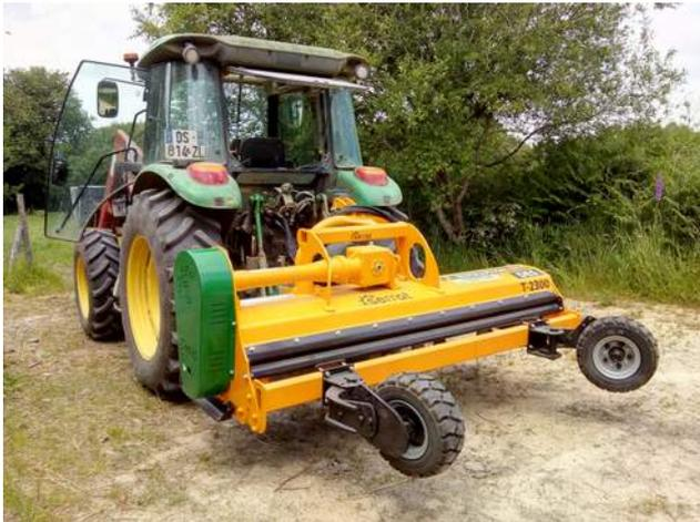
Un broyeur à axe horizontal.
